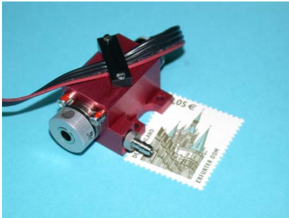
Bild 2: Rotary Bond Tool für Hochgeschwindigkeitsanwendungen mit einem Gesamtgewicht von 22 Gramm und einer Wiederholgenauigkeit von 0,005^\circ
