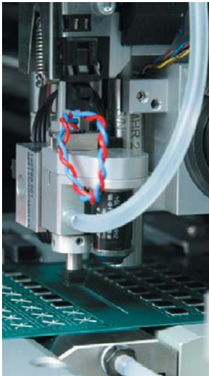
Abb. 4: Rotary Bond Tool mit Hohlwelle und optischem Sensor (Foto: Alphasem AG)
