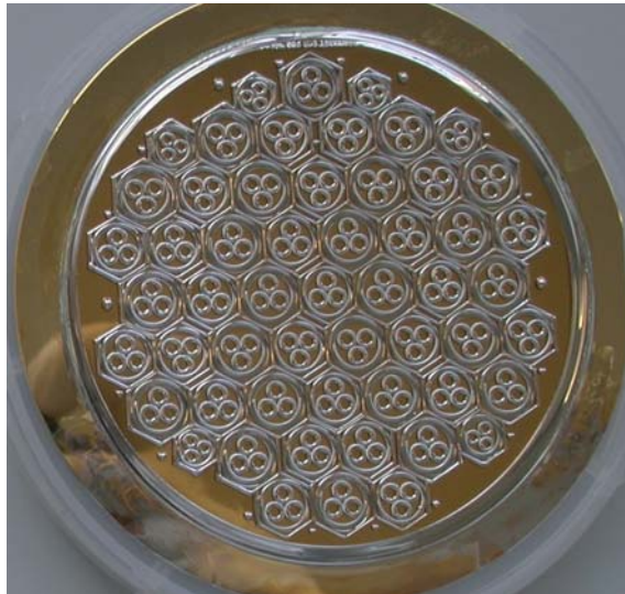
Bild 3: 4"-Silizium-Wafer nach der Galvanik mit gefüllten Zahnradstrukturen
