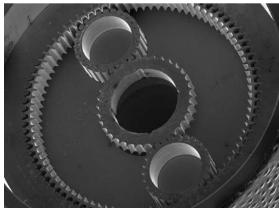
Bild 5: REM-Aufnahme eines vollständigen «Micro Harmonic Drive»-Getriebes des Typs MHD-10-16Q-P mit einem Aussendurchmesser von weniger als 10 mm
