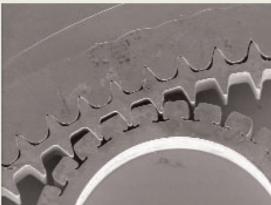
◀ Bild 6: Hinterschnitte sind notwendig, damit das Zahnrad in radialer Richtung flexibel bleibt
