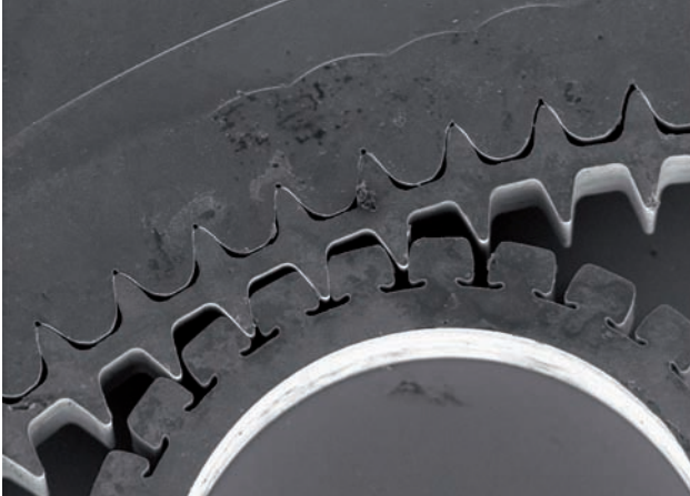
Bild 5. Ausschnitt eines Micro Harmonic Drive Getriebes mit markantem Planetenrad. Hinterschnitte sorgen für ein radial federndes Verhalten unabhängig von der Zahnraddicke.
