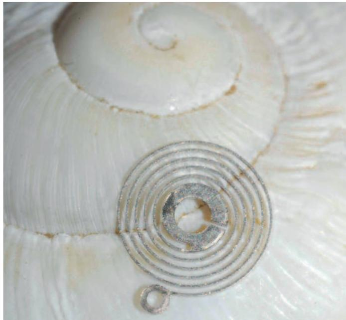
**Bild 6. Spiralfeder für die Uhrentechnik**
