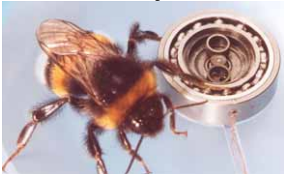
Bild 14: Ultra flaches Mikroantriebssystem: 13 mm Durchmesser und 4,3 mm axiale Länge
